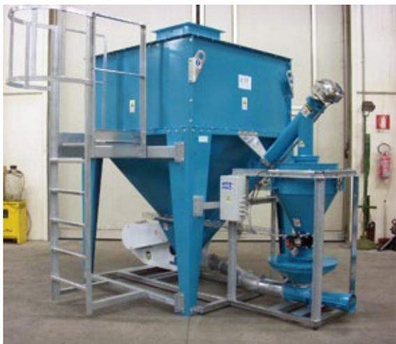
Sistema di trasporto pneumatico con pesatura a batch o continua
