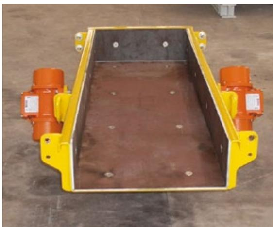
Alimentatore vibrante con rivestimento in HARDOX400
